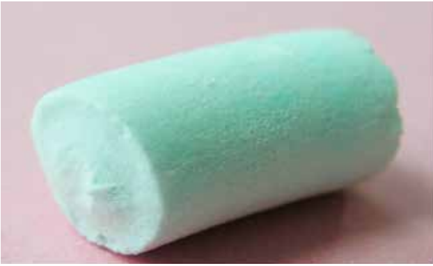
Рис. 2. Зовнішній вигляд експериментального зразка після термічного оброблення при t = 300\text{ }^{\circ}\text{C}
